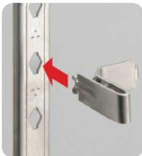
1 棚受を横向きにして上側を穴に差込む。
